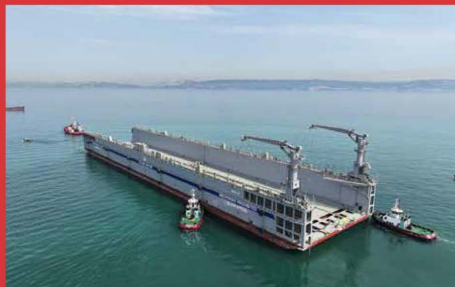
NB22 BLRT DOCK 10.000 TLC - 180 x 30 m
